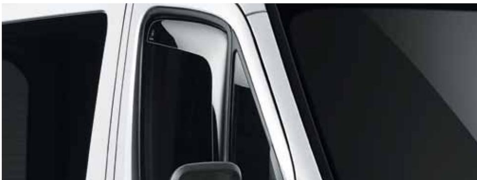
**Ветрозащитный спойлер для бокового стекла** монтируется с высокой точностью и предотвращает при слегка приоткрытом окне запотевание стекол и попадание в салон пыли, влаги и насекомых. Отсутствие сквозняков повышает уровень комфорта.
