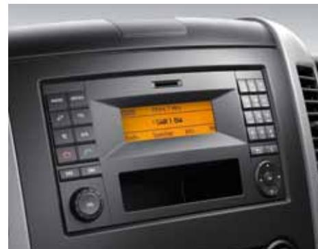
○ **Audio 10** с телефонной клавиатурой, интерфейсом Bluetooth®, разъемами USB и Aux-in, а также слотом для карт памяти SD.
