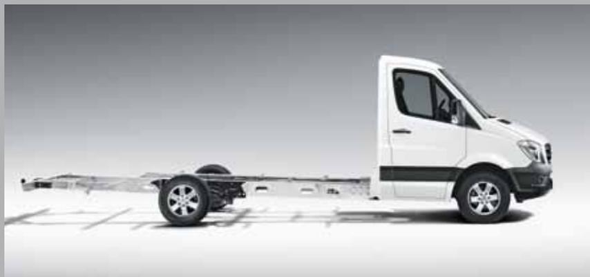
Для шасси Sprinter с ПНМ 3,5 т и 3,88 т предлагаются следующие варианты колесной базы: 3600, 3850 или 4100 мм; с ПНМ 4,2 т – 3850 и 4100 мм.
