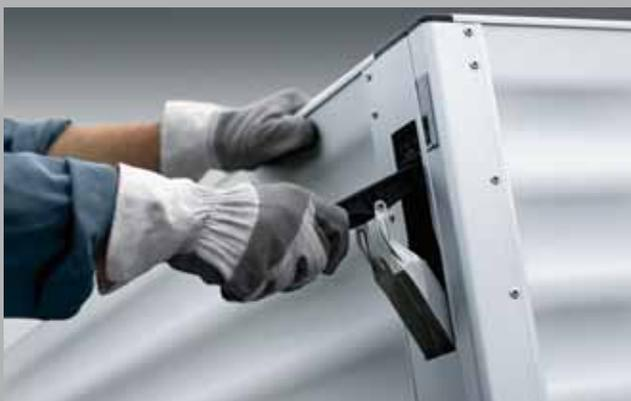
● **Легкоходные бортовые замки.** Нержавеющие бортовые замки упрощают откидывание бортов платформы.
