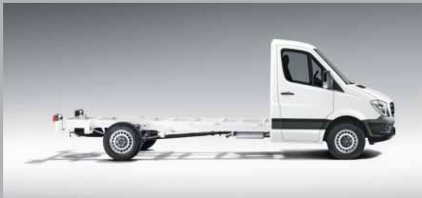
Для автомобилей Sprinter-шасси со стандартной рамой с ПНМ 3,5 т и 3,88 т предлагаются следующие варианты колесной базы: 3250, 3665 или 4325 мм; с ПНМ 5,0 т – 3665 и 4325 мм.
