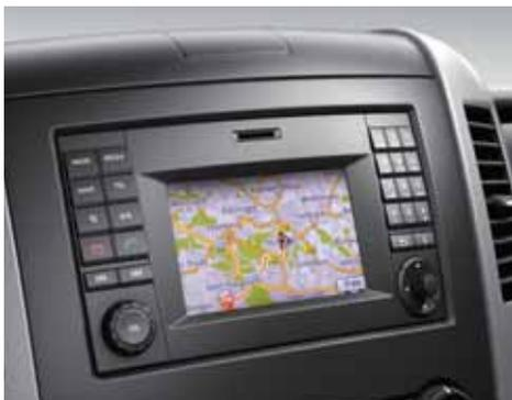
○ **Навигация** Becker® MAP PILOT<sup>6</sup> в комплектации с системой Audio 15.
