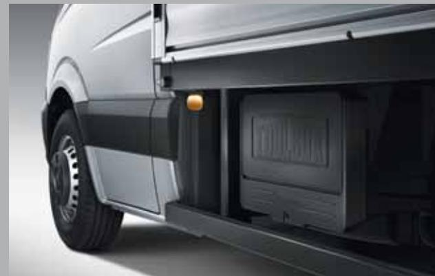
○ **Вещевые ящики под платформой слева и справа.** Ящики изготовлены из пластмассы и идеально подходят для хранения инструментов или багажа.
